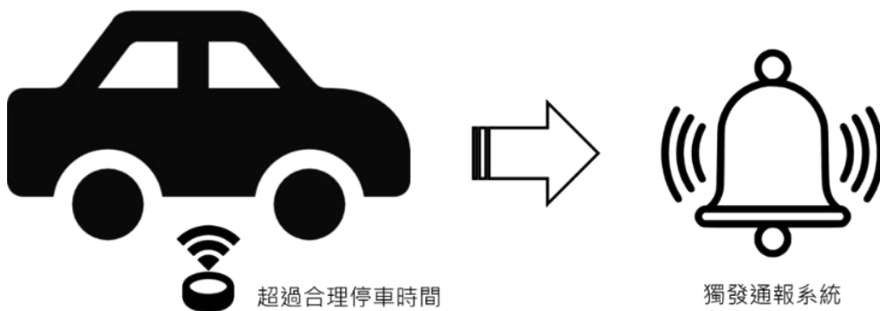
圖 8.3-5 地磁感測器功能示意
